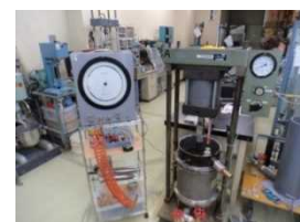
図 2-4 圧壊および透水試験装置
