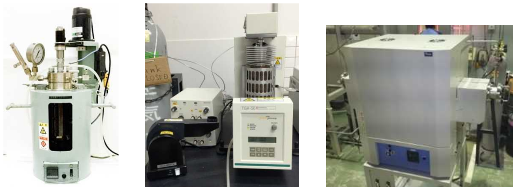
図 1-2 小型水熱装置(左)・小型ガラス溶融炉(中)・管状型電気炉(右)の外観
