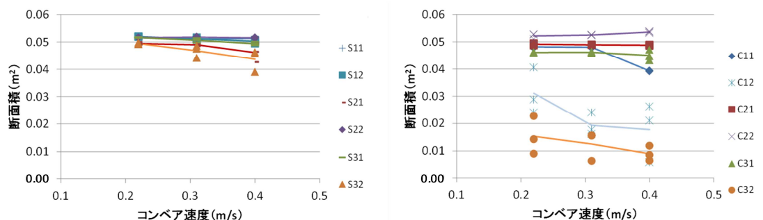
図 2-3 ベルトコンベア速度と断面積の関係
