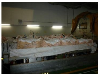
図 19 コンデンサー自動解体ラインの解体撤去物の処理状況 （左：低濃度抽出状況、右：真空超音波洗浄処理（洗いかご））
