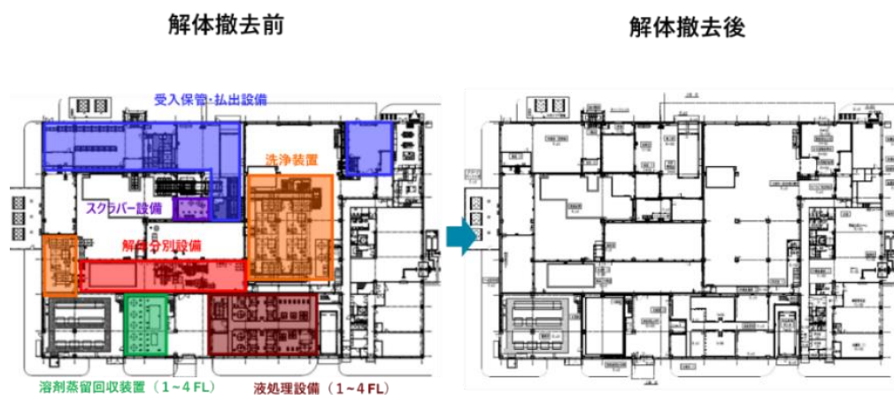
図 7 対象設備(解体撤去の前・後)
