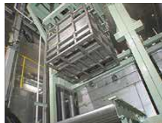
図 19 コンデンサー自動解体ラインの解体撤去物の処理状況 （左：低濃度抽出状況、右：真空超音波洗浄処理（洗いかご））
