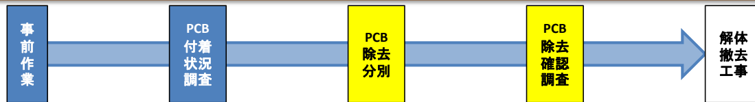
図 解体撤去フロー
