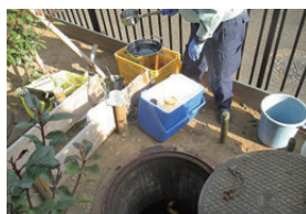
最終放流柵排水 サンプリング測定状況 (東京PCB処理事業所)
