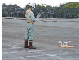
ドローンを用いた点検の様子
