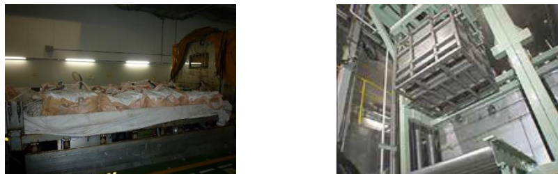
図 14 コンデンサー自動解体ラインの解体撤去物の処理状況 （左：低濃度払出し状況、右：真空超音波洗浄処理（洗いかご））
