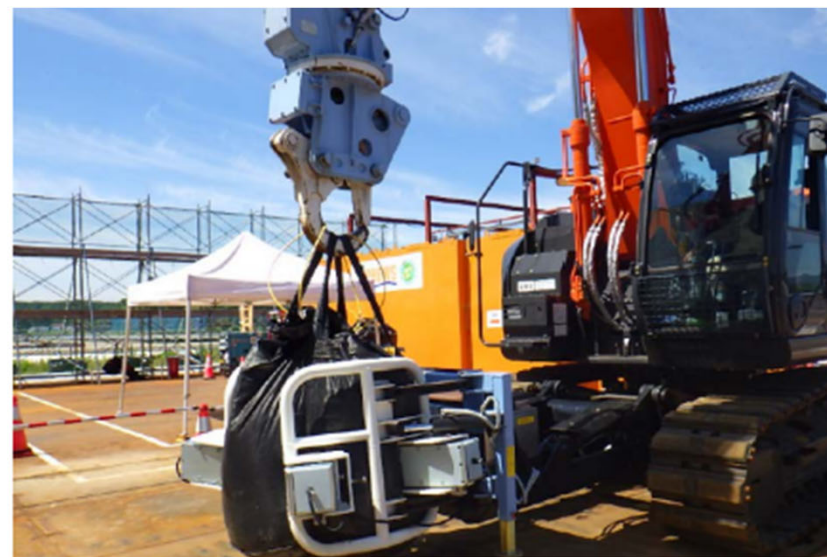
放射能計測駆動装置付小型移動式クレーン
