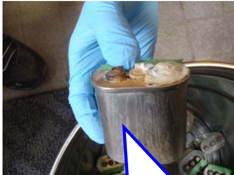
上面及び底面を除く側面（外周）の拭き取り
