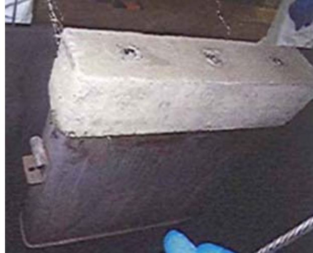
コンデンサーの一部をコンクリートで固化
