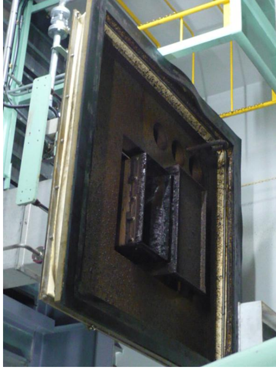
固形物充填槽の蓋 (中央部から固形物が充填され、 隣の3つの排気口から排気される)
