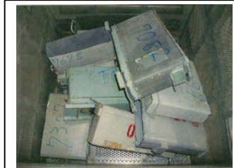
洗浄カゴ内の小型コンデンサ缶体（対策前）
