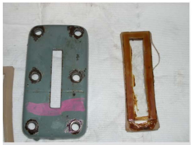
取り外した油面計
