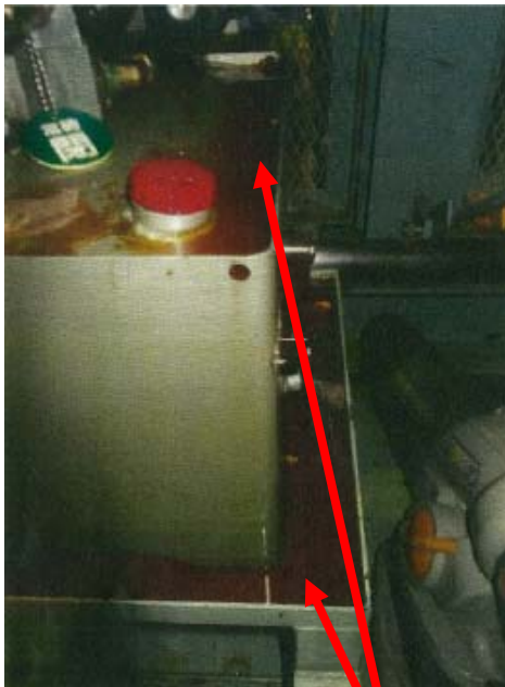
オイルパン内の作動油漏洩状況 (上部オイルパン、下部オイルパン に漏洩。床上漏洩はなし)
