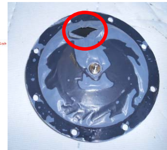
破損したダイヤフラム
