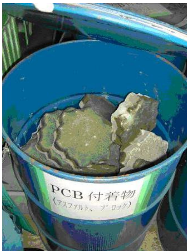
写真⑫ 汚泥（舗装用ブロック）
