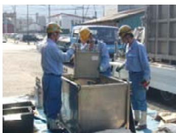
漏れ防止型金属容器に密閉構造の蓋(SUS)の取付
