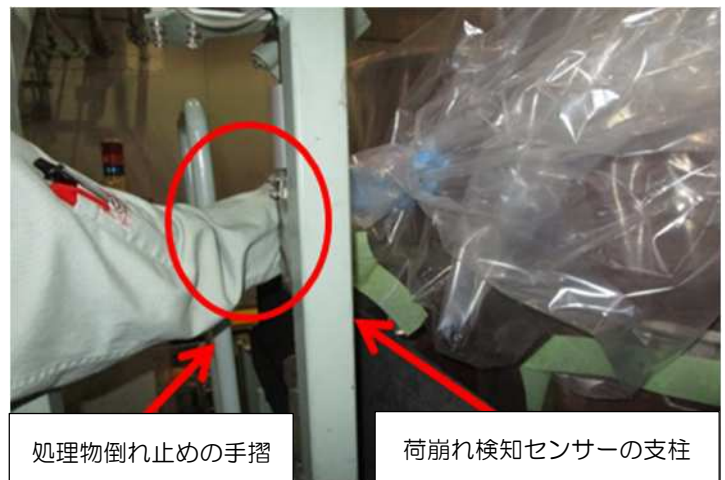
左手前腕を挟まれた状況（再現写真）
