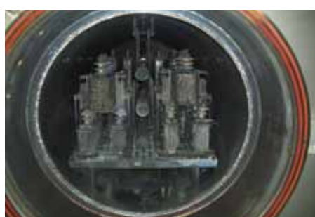
真空加熱分離装置でのコンデンサ処理(引渡性能試験) (左：処理前、右：処理後)
