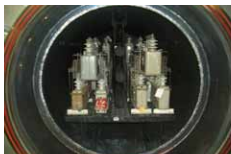
真空加熱分離装置でのコンデンサ処理(引渡性能試験) (左：処理前、右：処理後)
