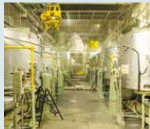
●含浸物洗浄設備(攪拌洗浄) 含浸性部材を溶剤で攪拌洗浄し、PCBを洗い落とします。
