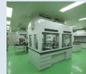
●分析室 施設内で処理された処理対象物に、基準以上のPCBが含まれていないかを調べて卒業判定を行います。
