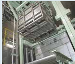
●非含浸物洗浄設備 鉄や銅、端子などのPCBが浸み込んでいない非含浸性部材を真空超音波洗浄装置で洗浄し、PCBを取り除きます。
