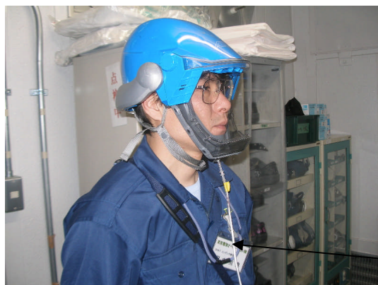
写真13 保護マスクフィット測定： 全面形陽圧式マスク内に測定管を入れて、マスク内外の粒子量を測定することによりフィット性を確認する。
