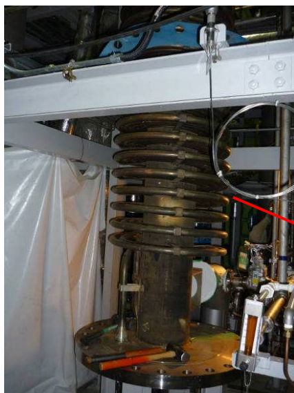
写真 3 冷却部：らせん状配管
