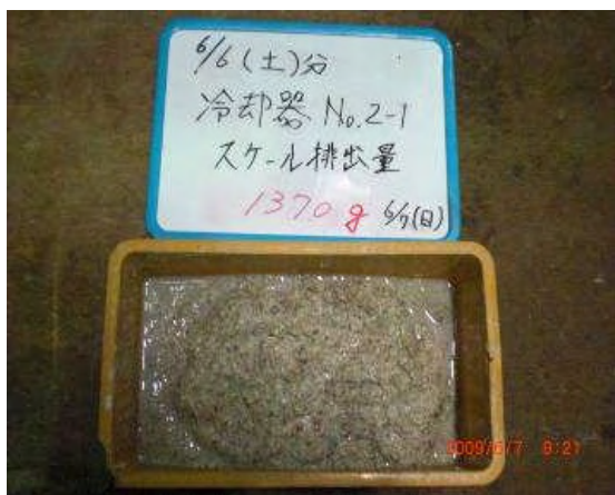
写真 3 冷却器に付着したスケール
