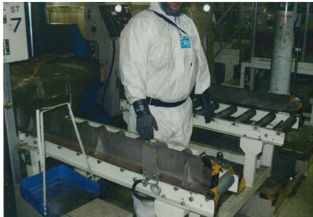
写真6 パレットステーションにおける挟まれ事故（想定）
