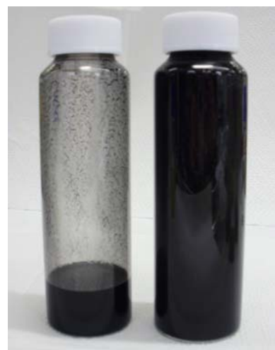
写真 2 左：PCB 油を加えた状態 右：水分を加えた状態
