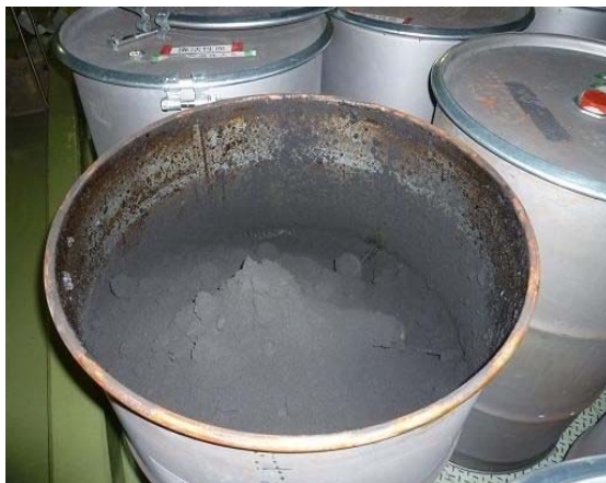
写真 1 試験に用いた粉末活性炭 (タール等を含む PCB 油を 処理したもの。PCB 濃度は 25%前後)
