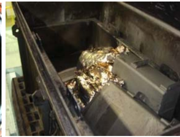
(鋼製ケース内処理後、穴から内部 構成部材がケース内に出ている)
