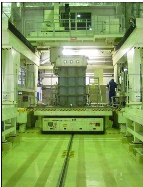
大型五面加工機によるトランス容器切断
