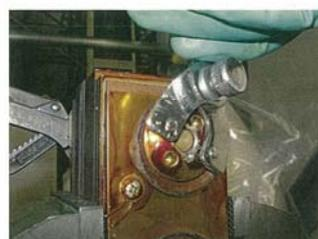
専用治具でナットを緩めて外す。上下2本取外した後に鉄心を解体する。
