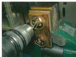
鉄心ブロックをバイスに固定し貫通ボルトナットのゆるみ防止ポンチ加工部を3.5mmドリルで削り取る。
