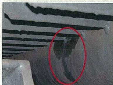
放熱器溶接部からのしみ漏れ
