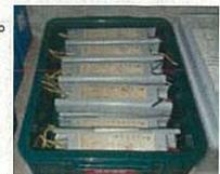
■微量のPCBが混入した絶縁油に汚染された電気機器(微量PCB汚染廃電気機器等)
