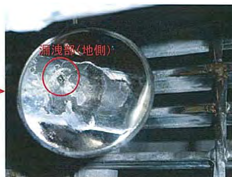
図4 漏洩部拡大写真
