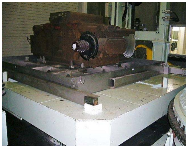
車載トランスの外観
