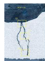
図14 SCC (応力腐食割れ)
