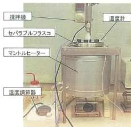
写真-1 加水分解試験装置の外観
