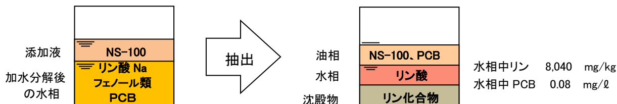
図-3 抽出によるPCB除去
