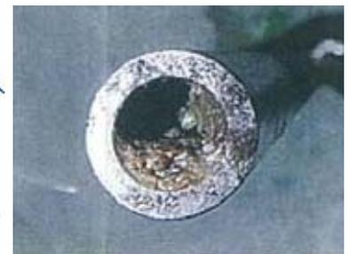
図 11 スラリー投入管先端部の閉塞状況
