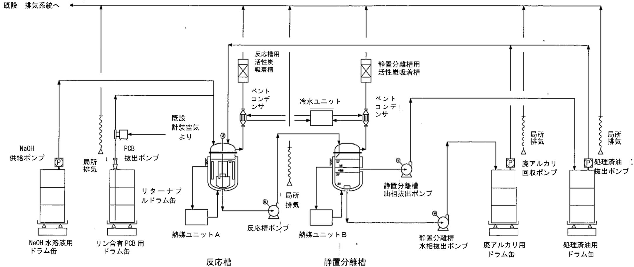
リン化合物含有 PCB 油前処理設備 実証設備構成図
