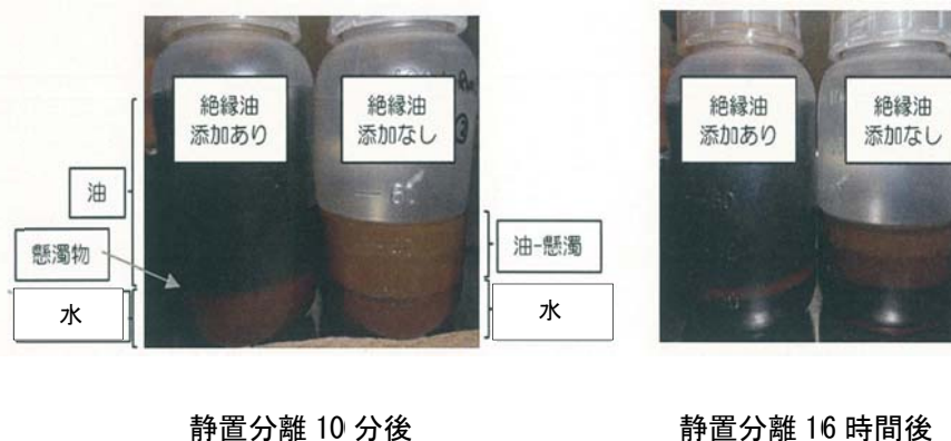
図-4 絶縁油添加による懸濁物の沈殿効果
