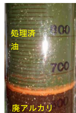
写真1 絶縁油添加 （希釈倍率 1.5 倍） 後の分離状況例
