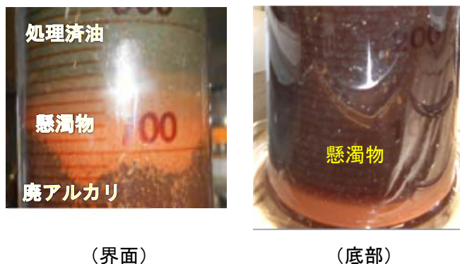
写真3 L油繰り返し処理時の懸濁物の状況
