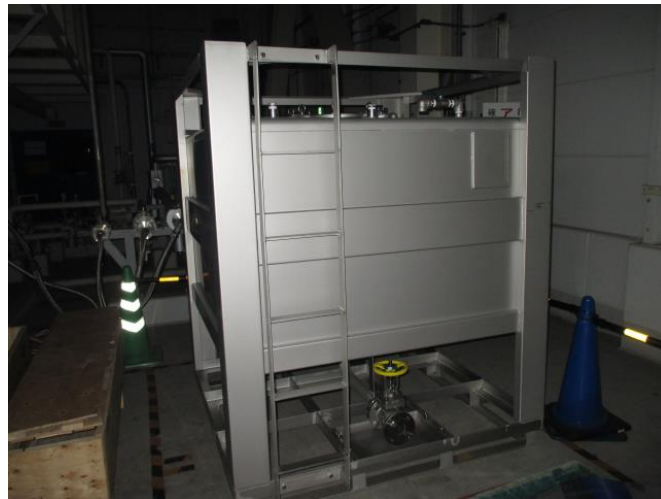
図 2. 廃アルカリ液運搬用 2m 3 コンテナ (外形概略寸法:幅 1,510 mm×奥行 1,510 mm×高さ 1,830 mm)
