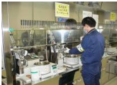
手分析によるPCB濃度測定分析のための前処理工程
