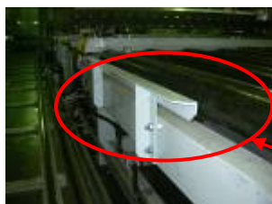
写真1-5 小型トランス乗継時の転倒対策
