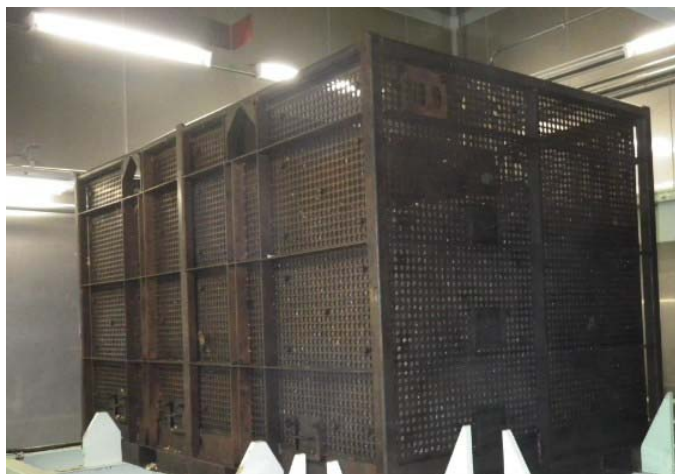
含浸性部材を入れる加熱カゴ
