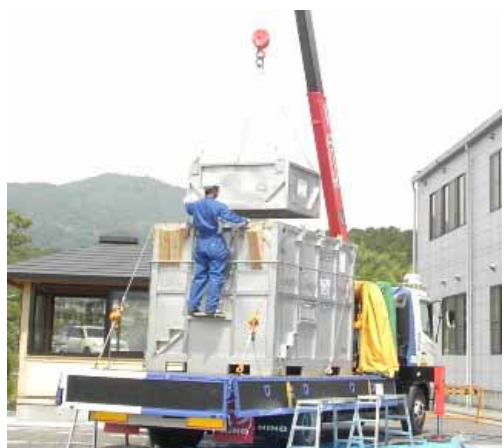
PCB廃棄物を入れたインナーコンテナを密閉容器へ積み込み
