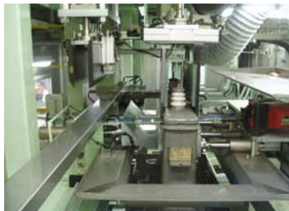
コンデンサからPCBを抜き出した後に蓋を切断
