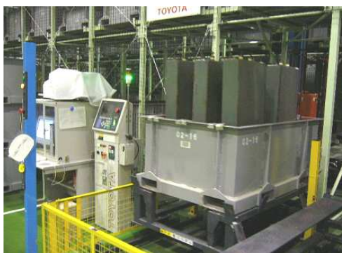
受け入れたコンデンサ・小型トランスは自動立体倉庫で一時保管
