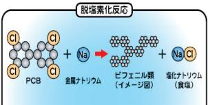
これらの処理方式の中から、豊田PCB処理事業所では、脱塩素化分解方式(反応)を採用しています。
