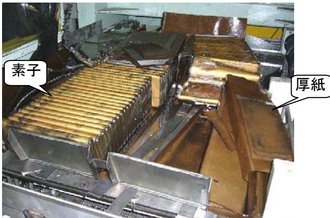
コンデンサ解体ラインで素子を包む厚紙を剥がしたところ
