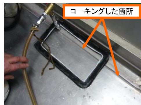
コーキングした箇所について検査 (真空発泡漏れ試験)
