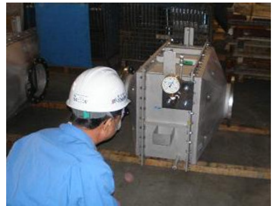
交換する熱交換器の現物検査 (工場検査における耐圧試験)
