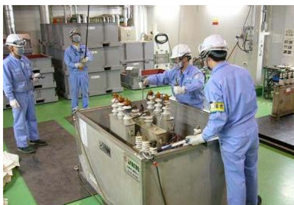
受入検査室におけるコンデンサの取出作業
