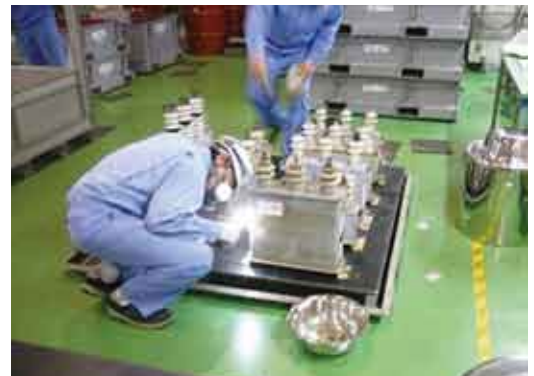
受け入れたコンデンサについてPCB油が漏れていないかを確認
