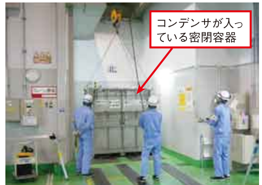
コンデンサを密閉容器ごと受入検査室に受け入れ
