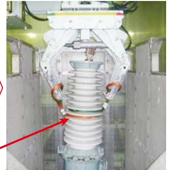
抜油・浸漬後、解体前洗浄し、カゴから取り出す
