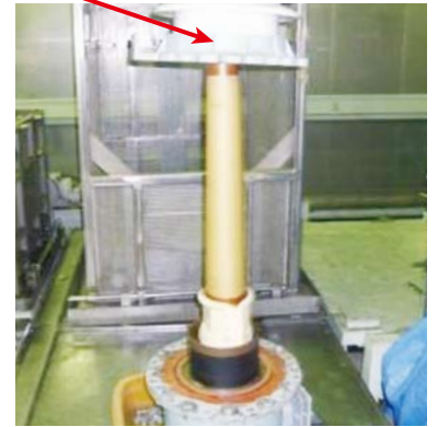
解体ラインで碍子とコアを分離
