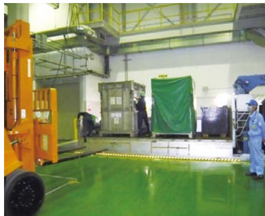
収集運搬車から漏れ防止型金属容器を降ろす様子
