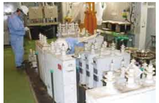
コンデンサの重量を測定
