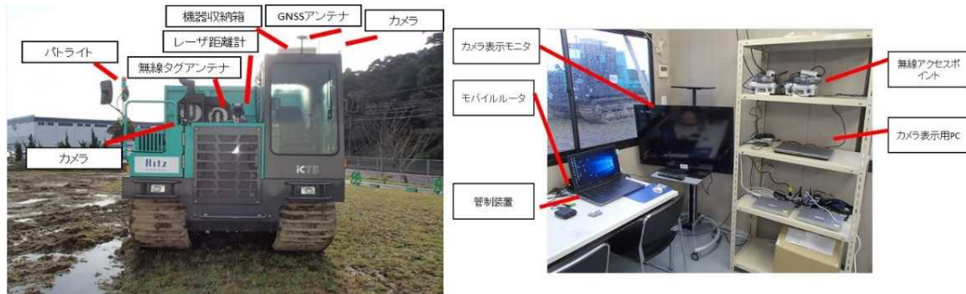
図 2-2 試験設備（左：クローラ、右：管制システム）
