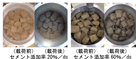
図 2-8 圧壊試験前後の脱水固化碎石の状況
