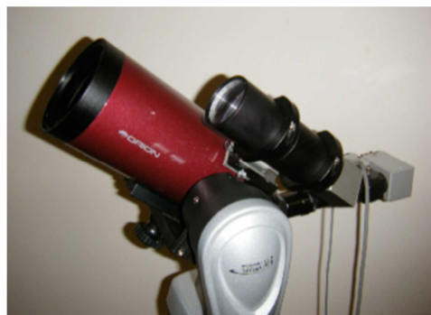
図 1-2 小型偏光ライダー 図 1-3 小型偏光ライダーによる観測イメージ
