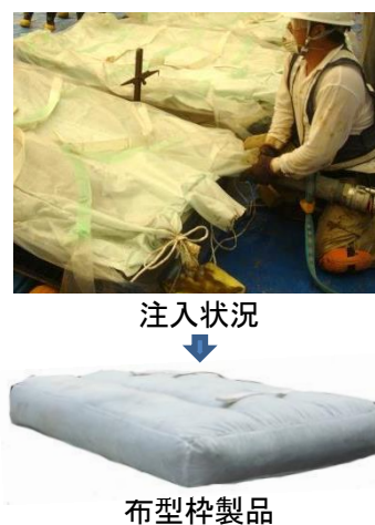
図 1-5 製作設備（布型枠製品の製作実証試験）
