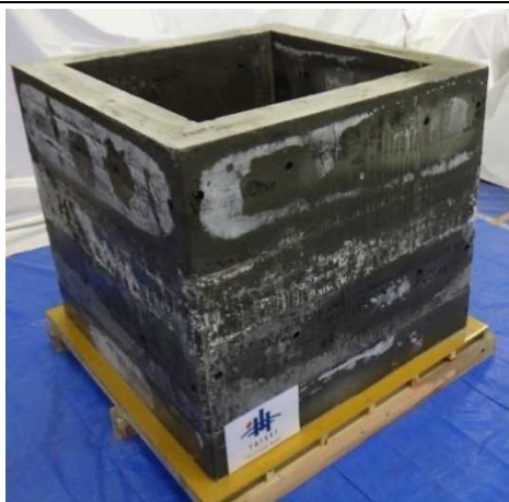
図 3-9 貯蔵容器の外観状況（脱型後）
