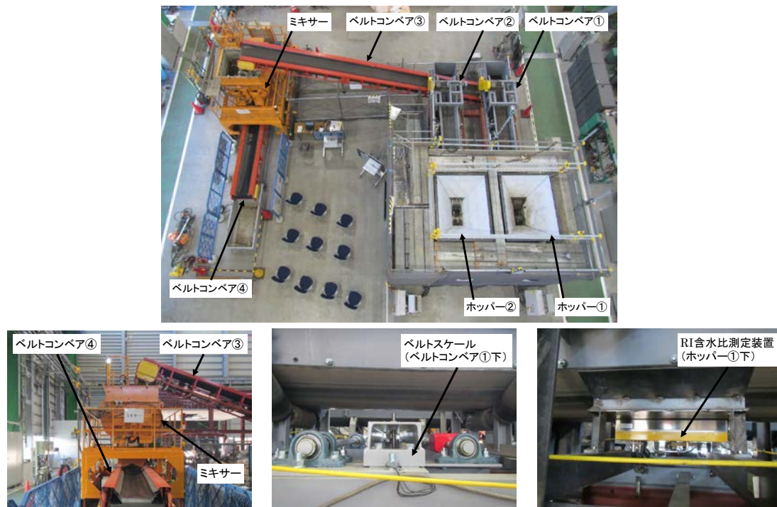
図 1-5 試験装置および測定機器
