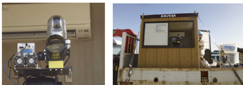
図 3-4 小型偏光ライダー （左：小型偏光ライダー本体、右：観測小屋）
